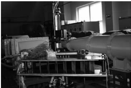
图 2 压气机叶栅实验段照片
